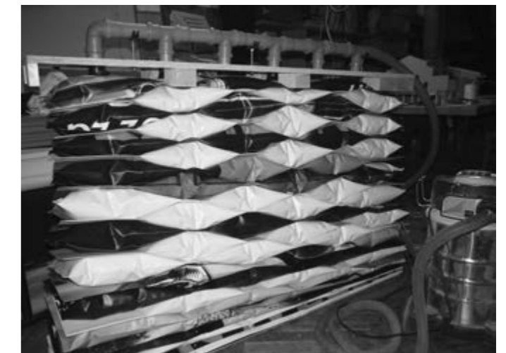
Dominika Szabová: Prototyp nafukovacieho akustického a termálneho izolačného panelu, vyrobeného z použitých reklamných bannerov.
